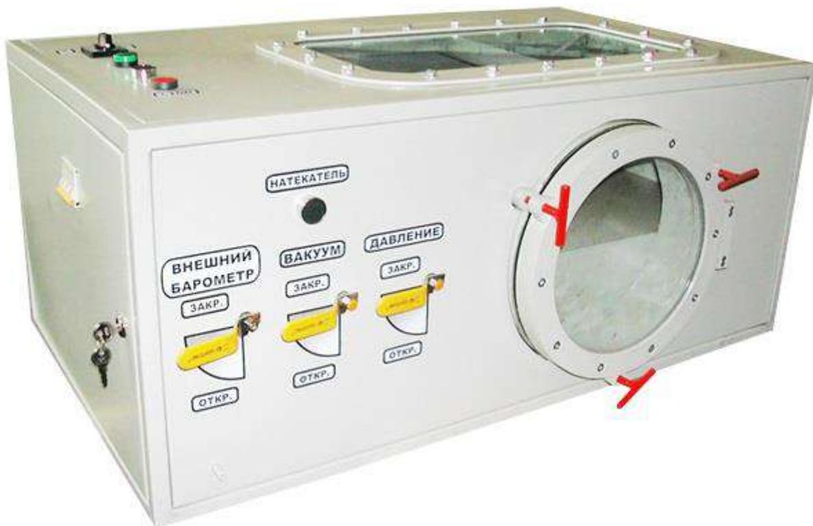
Установка барометрическая для поверки барометров
