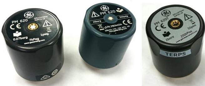
Рисунок 5 – Модули давления PM 620 и PM 620T
