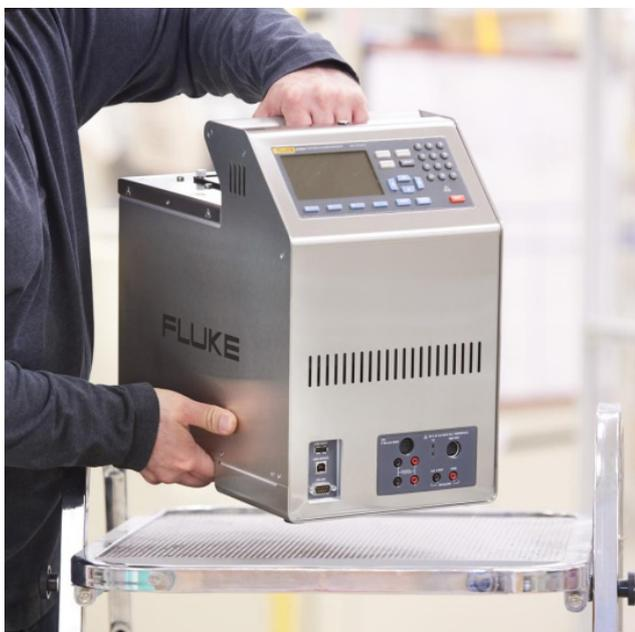
Новые модели портативных калибровочных термостатов от компании Fluke Calibration позволяют разрешить обе эти важные проблемы современных производств. Модели 6109A и 7109A – это портативные жидкостные термостаты, которые предназначены для работы прежде всего не в лаборатории, а прямо в цехах, на местах установки поверяемых датчиков. Это позволяет коренным образом сокращать время простоев оборудования на производствах. Кроме того, конструкция и
