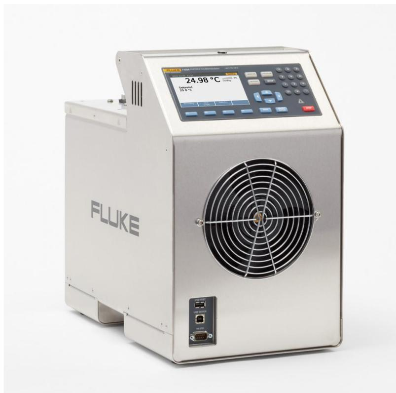
Портативный поверочный термостат с увеличенной пропускной способностью и вдвое лучшей точностью по сравнению с обычными микро-ваннами и сухоблочными калибраторами.
