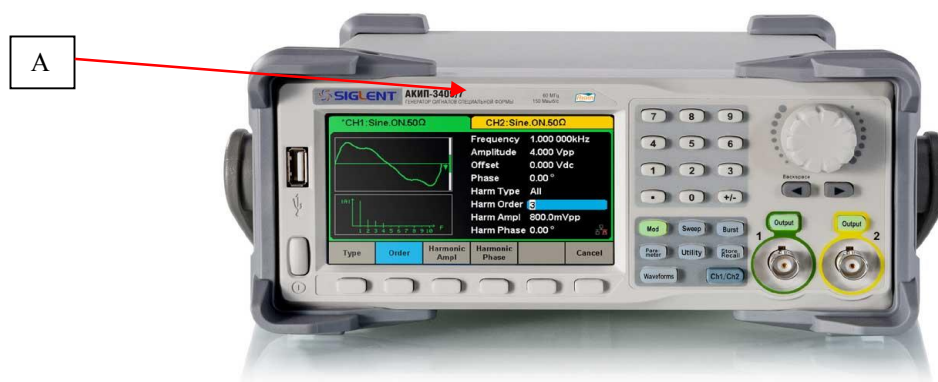
Рисунок 1 – Внешний вид генераторов и место нанесения знака утверждения типа (А)
