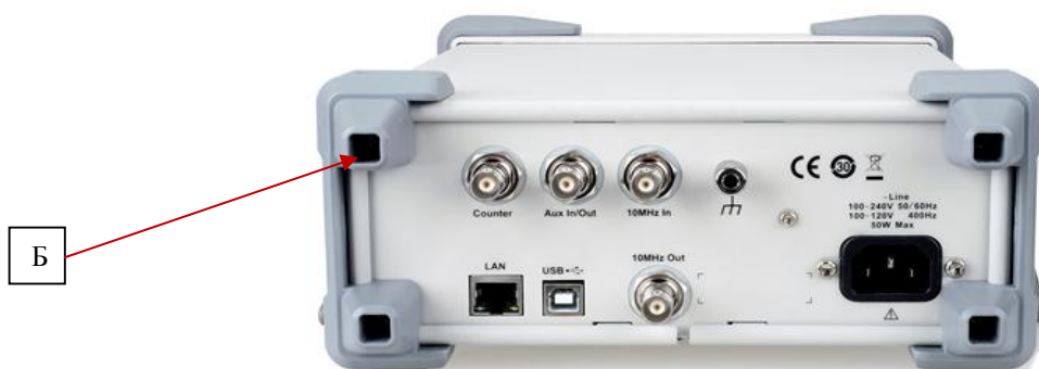
Рисунок 2 – Вид задней панели и место опломбирования от несанкционированного доступа (Б)
