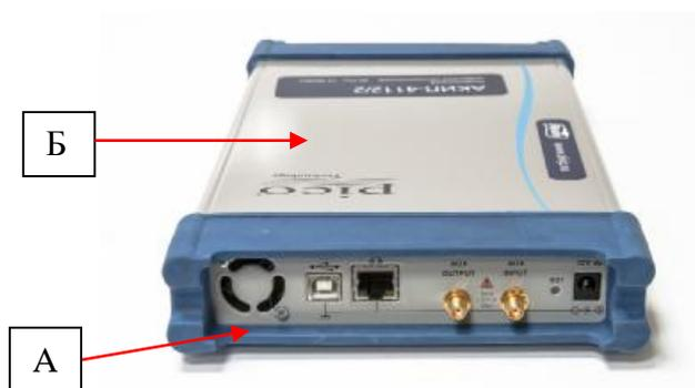
Рисунок 2 – Схема пломбировки от несанкционированного доступа (А) и нанесения знака поверки (Б)
