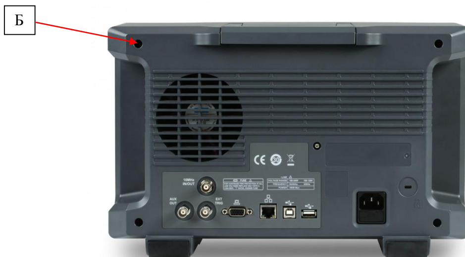
Рисунок 2 – Вид задней панели осциллографов и схема пломбировки от несанкционированного доступа (Б)
