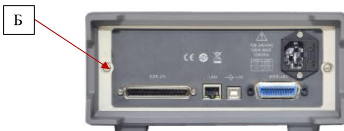
Рисунок 2 – Схема пломбировки от несанкционированного доступа (Б)
