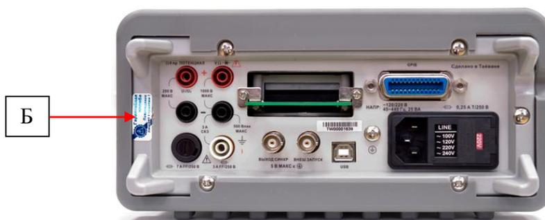
Рисунок 4 - Схема пломбировки от несанкционированного доступа (Б)
