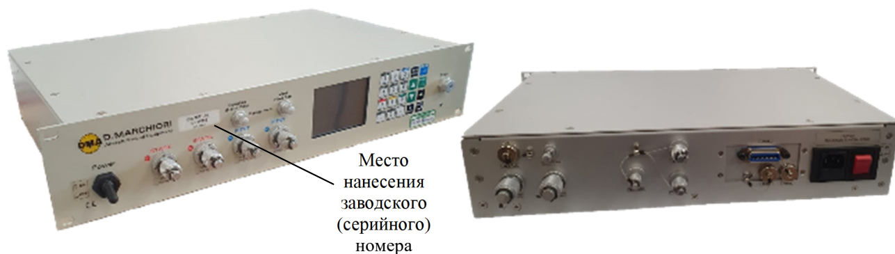
Рисунок 1 – Общий вид калибраторов давления MPS46 с указанием места нанесения заводского (серийного) номера
