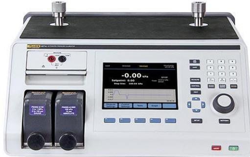
Калибратор 2271A работает в диапазоне давлений от -100 кПа до 20 МПа (-15 до 3 000 фунтов на кв. дюйм), Два уровня точности: 0,01 % от показаний или 0,02 % от полной шкалы.
