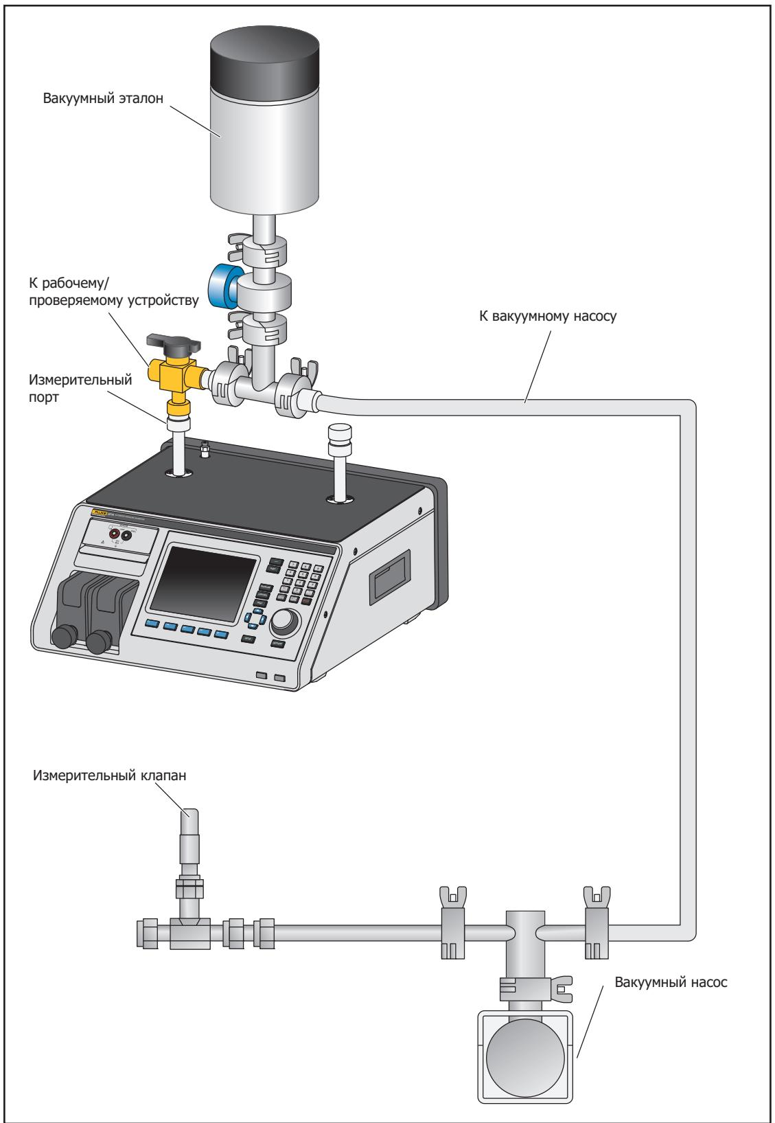
**Рисунок 14. Обнуление с помощью настройки вакуума**
