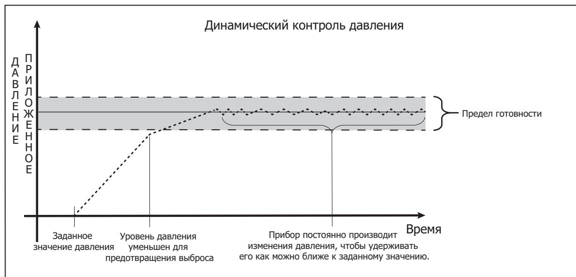
Рисунок 11. Пример режима динамического контроля давления
