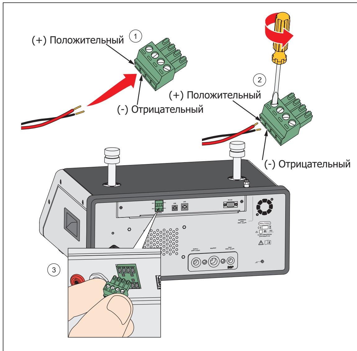
Рисунок 28. Соединения драйвера
