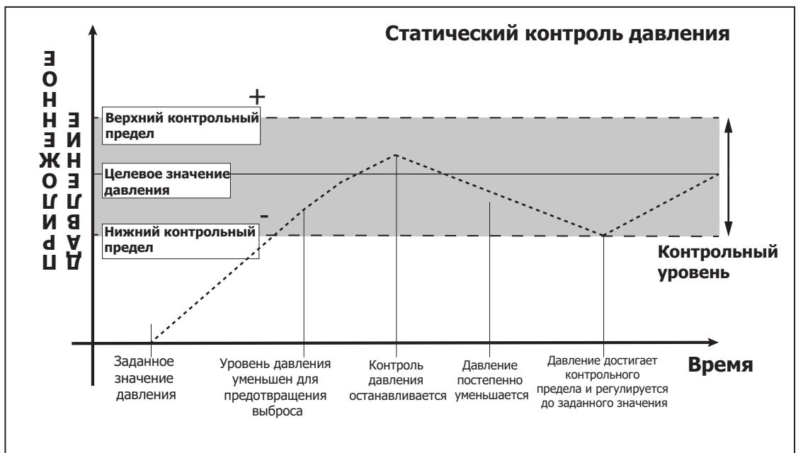
Рисунок 12. Пример режима статического контроля давления
