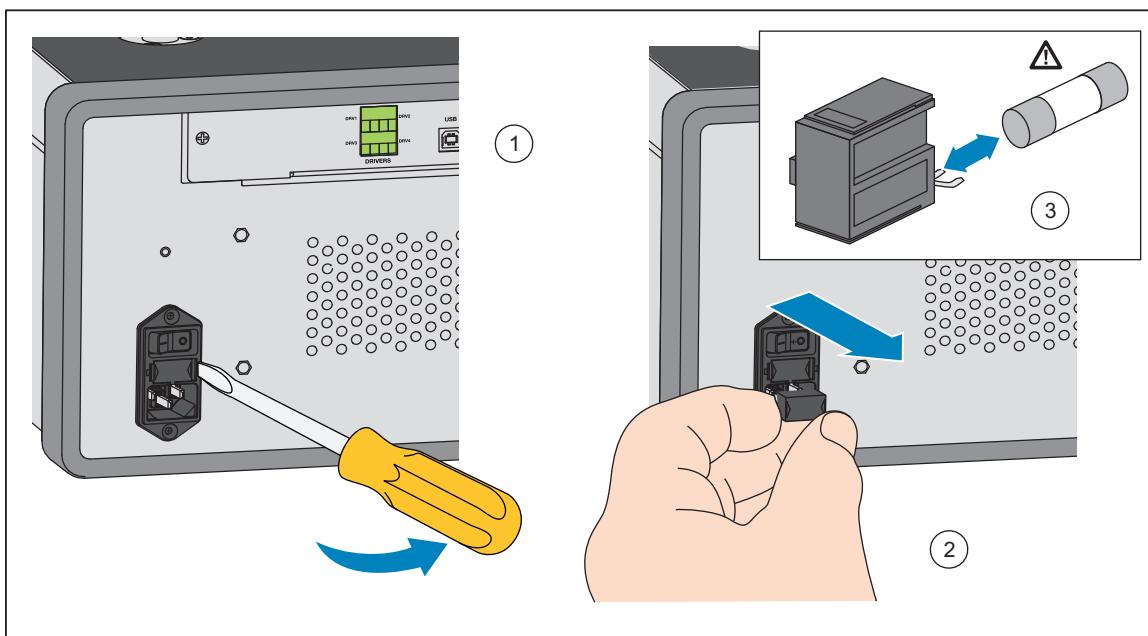
**Рисунок 29. Доступ к предохранителю**
