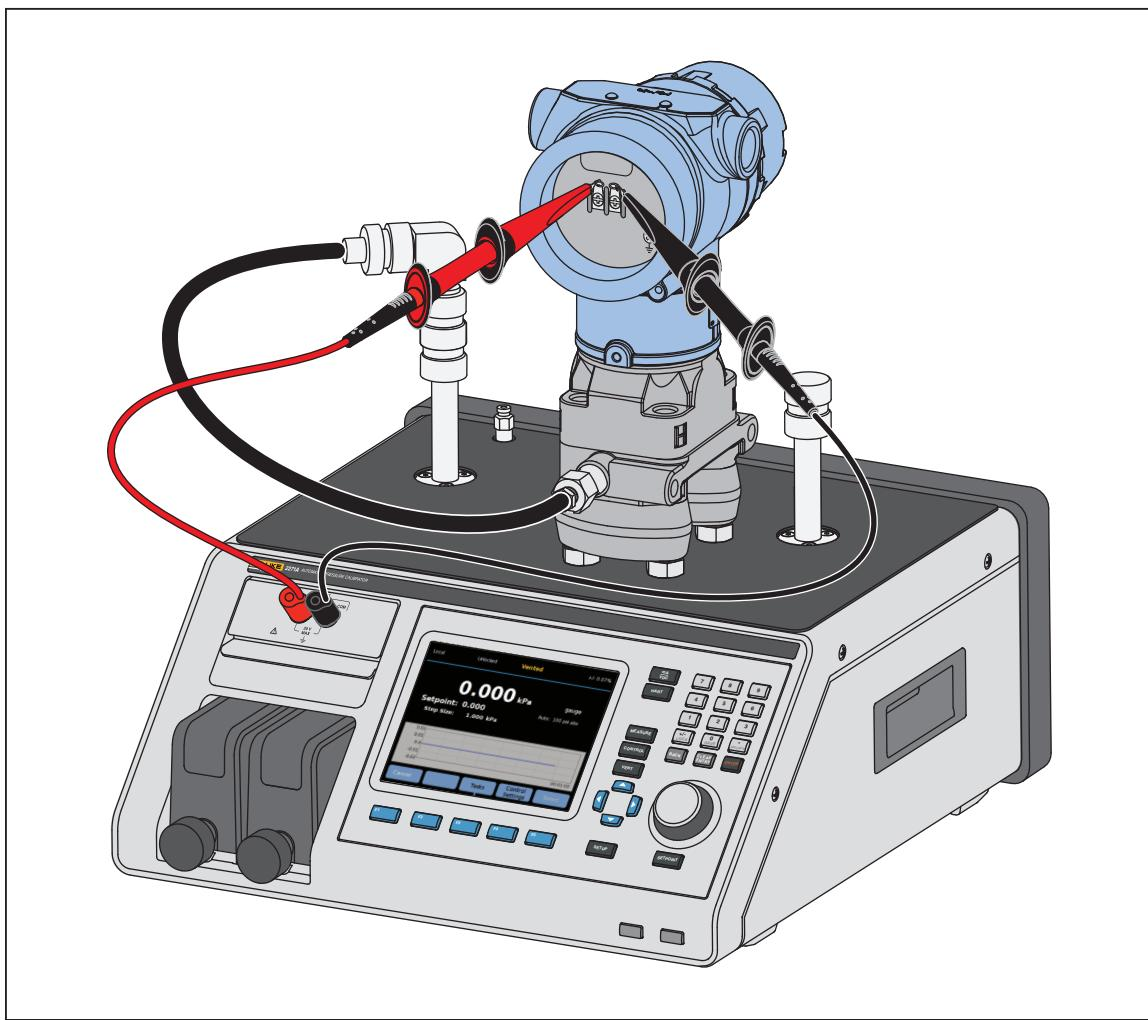
Рисунок 16. Стандартное подключение дифференциального датчика с помощью протокола HART через модуль EMM и измерительный порт
