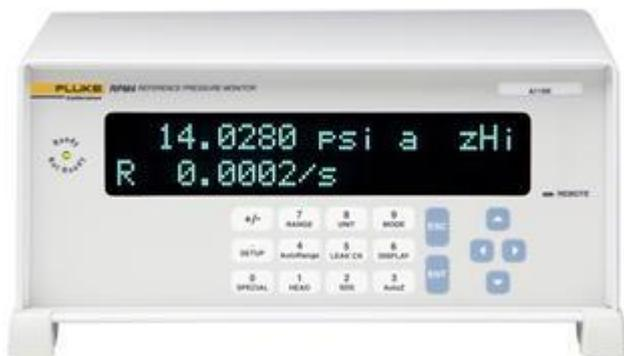
Калибраторы давления Fluke RPM4 применяются в лабораториях по поверке, калибровке и ремонту средств измерения давления. Верхний предел измерения с модулями Q-RPT от 10кПа избыточное давление до 280МПа, от 110кПа абсолютное давление до 280МПа;
