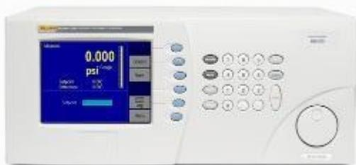
Модель 7250 предлагает экономичное решение для автоматического тестирования и калибровки давления с точностью 0,003 % всей шкалы для диапазонов до 17,2 МПа. Для шкалы до 21 МПа точность составляет 0,012 % от показания на диапазоне от 6,3 до 21 МПа. Модели 7250xi и 7250i обеспечивают более высокий уровень точности показаний для повышения производительности одного прибора, что снижает затраты по калибровке большого количества устройств для измерения давления и диапазонов этих устройств.
