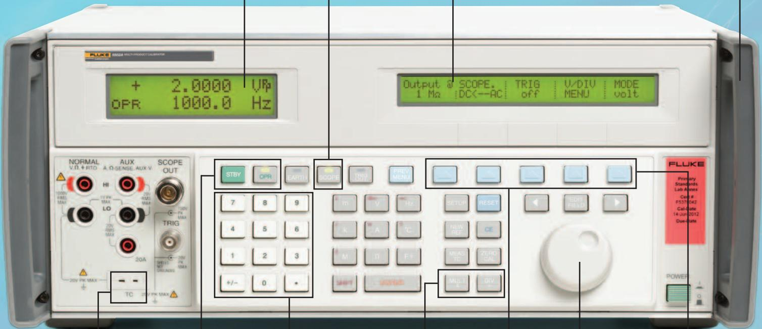
Управление выходными сигналами с помощью клавиш **STBY** и **OPR**.
