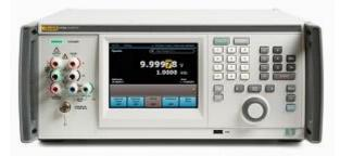
Калибраторы многофункциональные Fluke 5730A с усилителем Fluke 5725A предназначены для воспроизведения напряжения постоянного и переменного тока, силы постоянного и переменного тока, сопротивления постоянному току, частоты напряжения переменного тока.
