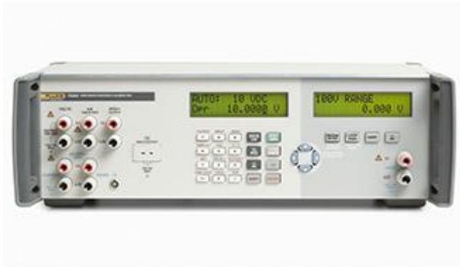
Высокоточный промышленный калибратор Fluke 7526A от компании Fluke Calibration — это оптимальное соотношение между экономией и точностью для настольной калибровки промышленного оборудования для измерения температуры и давления. Обеспечивает легкую калибровку показаний термодатчиков и RTD, манометров, температурных датчиков, цифровых симуляторов технологических процессов, регистраторов данных, мультиметров и многих других видов оборудования.
