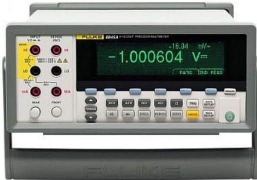
Мультиметры Fluke 8846A предназначены для измерения напряжения, сопротивления, силы тока. Базовая точность измерения напряжения постоянного тока составляет до 0,0024 %, диапазон силы тока 10 А.
