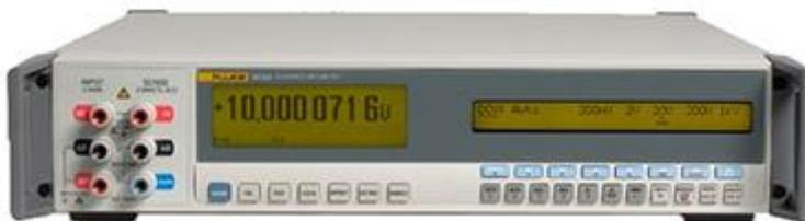
Fluke 8508A представляет собой прибор с 8,5 разрядами точности, разработанный специально для метрологов. Обладающая превосходной точностью и стабильностью в широком диапазоне измерений, модель 8508A спроектирована как многофункциональный прецизионный измерительный инструмент для калибровочных лабораторий, в которых требуется соблюдение все более возрастающих требований по анализу погрешностей согласно стандарту ISO 17025, а также растущих требований к производительности.
