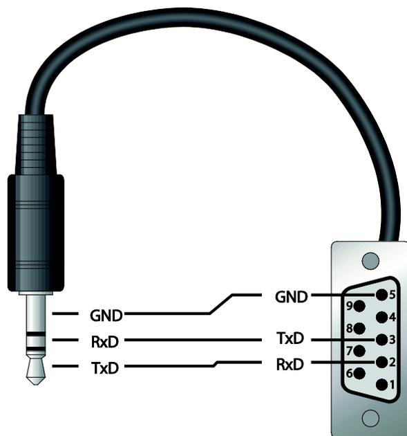
Рисунок 4. Схема разводки последовательного кабеля
