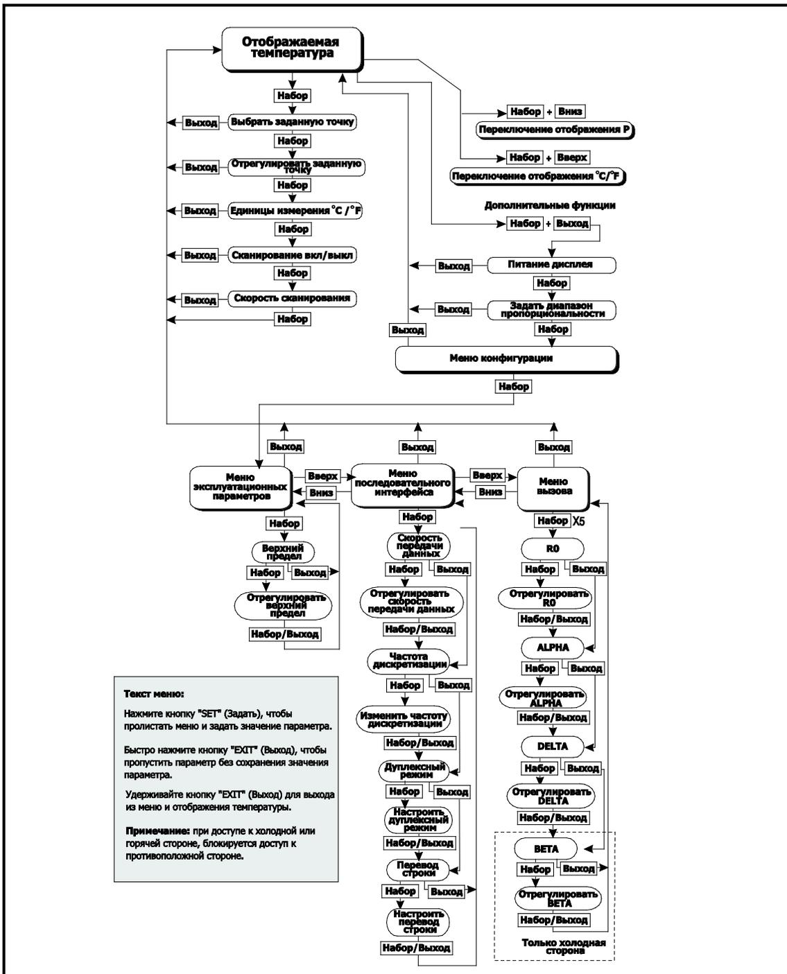
Рисунок 3. Эксплуатационная блок-схема контроллера
