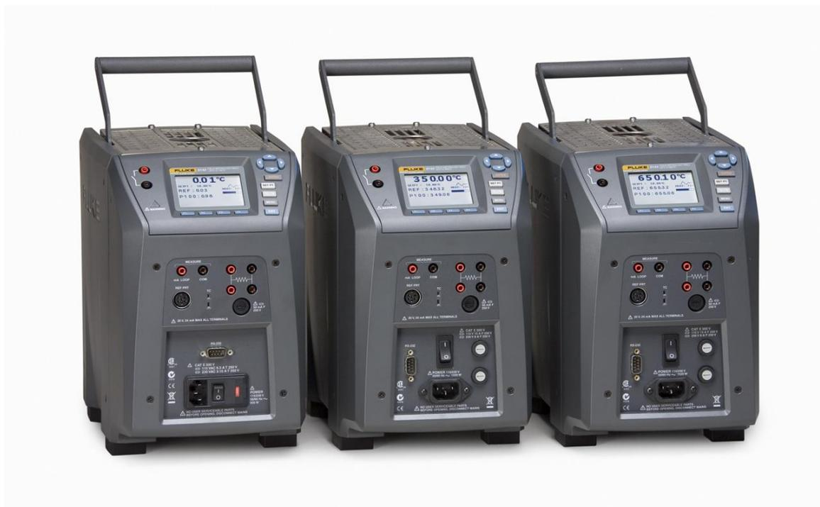
Полевые сухоблочные термостаты **Fluke 9142, Fluke 9143, Fluke 9144** Field Metrology Well разработаны с учетом использования в промышленных условиях. Они весят менее 8,2 кг и весьма компактны, что позволяет их легко транспортировать к месту использования. Будучи оптимизированными по быстродействию, полевые сухоблочные термостаты Field Metrology Well охлаждаются до  $-25$  °C за 15 минут и нагреваются до  $660$  °C также за 15 минут.
