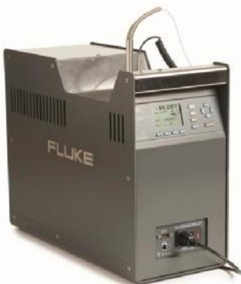
Рис.1. Калибратор модели 9190А
