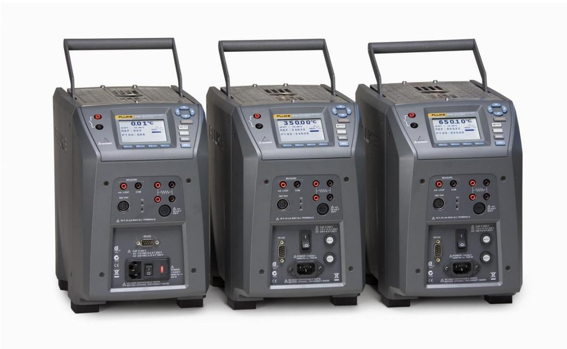
Полевые сухоблочные термостаты **Fluke 9142, Fluke 9143, Fluke 9144** Field Metrology Well разработаны с учетом использования в промышленных условиях. Они весят менее 8,2 кг и весьма компактны, что позволяет их легко транспортировать к месту использования. Будучи оптимизированными по быстродействию, полевые сухоблочные термостаты Field Metrology Well охлаждаются до –25 °С за 15 минут и нагреваются до 660 °С также за 15 минут.
