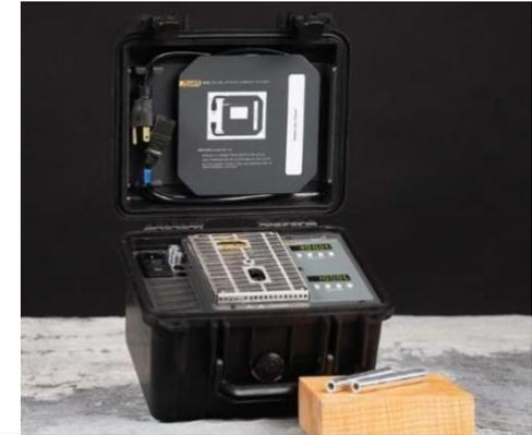
**Портативный двухдиапазонный сухоблочный калибратор, диапазоны от -15 °C до 110 °C и от 50 °C до 350 °C**
