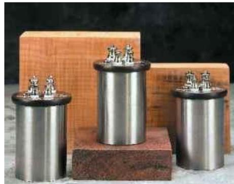
**Взрывобезопасные электронные термометры со встроенным сенсором Stick**
