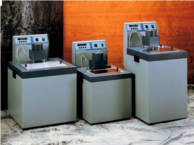
Калибровки методом сличения требуют наличия источника стабильного и равномерного тепла, а для умеренно высоких температур масляные поверочные термостаты Fluke Calibration являются самым лучшим источником тепла.
