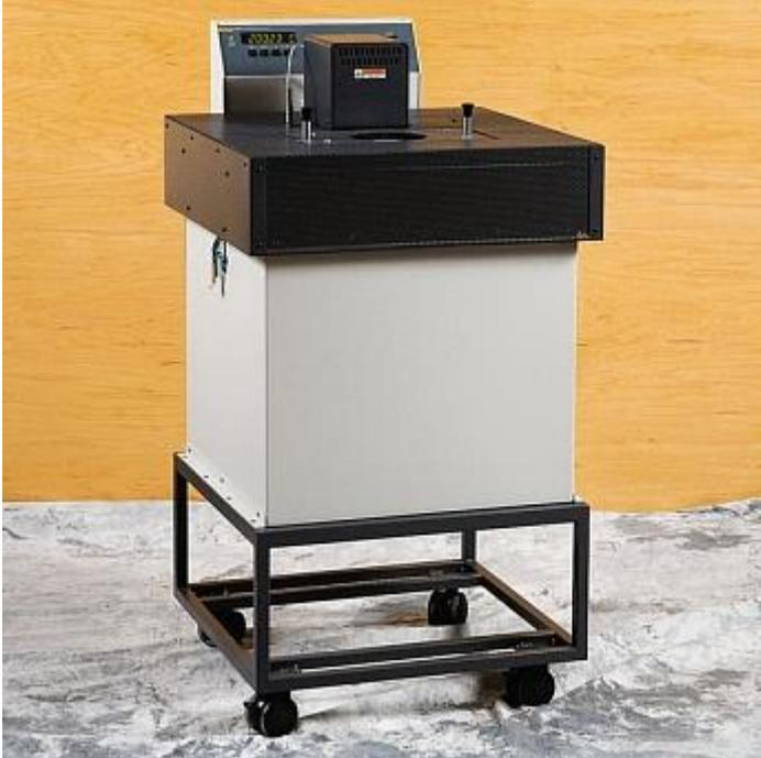
Термостат Fluke 5060H предназначен для высокотемпературной калибровки до +550 °С;
