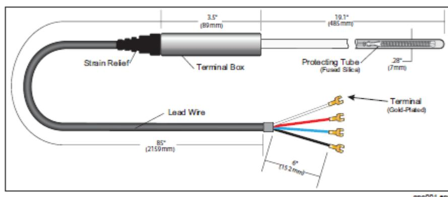
Рабочий эталон SPRT 5698 соответствует требованиям МТШ-90 к SPRT и включает разработанный компанией Hart Scientific недеформирующийся платиновый датчик. Этот 25-Омный SPRT с 485-миллиметровым кварцевым корпусом охватывает диапазон температур от  $-200$  до  $670$  °С. Долговременный дрейф, который мы определяем как изменение выходного сопротивления в тройной точке воды после 100 часов при  $670$  °С, составляет (после конвертации в температуру) менее 6 мК и обычно менее 3 мК.
