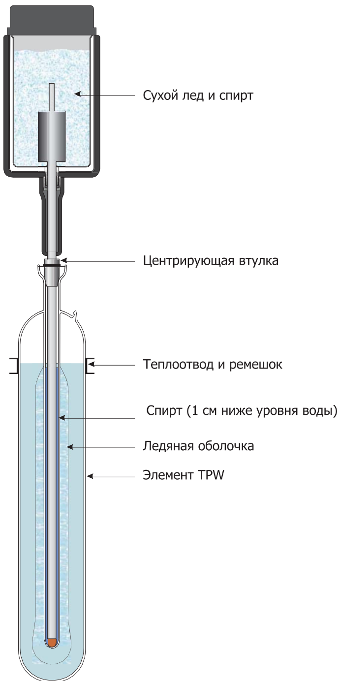
Рис. 2. Замораживание ледяной оболочки с помощью Quick Stick
