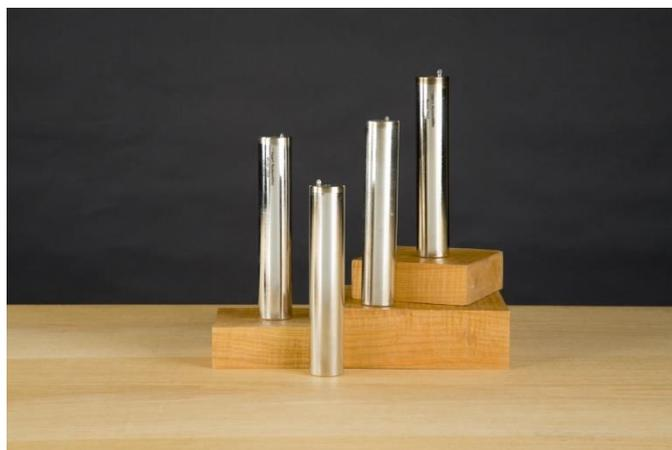
Мини-ампулы позволяют уменьшить необходимость в сложной калибровке методом сличения. Температуры ампул реперных точек постоянны и подлинны, поэтому считывать нужно только электрические параметры калибруемых сенсоров. При этом калибровка по реперным точкам позволяет достигать высшей возможной точности. Мини-ампулы Fluke охватывают диапазон от тройной точки воды (0,01 °С) и включает все точки затвердевания металлов от индия (156,5985 °С) до меди (1084,62 °С).
