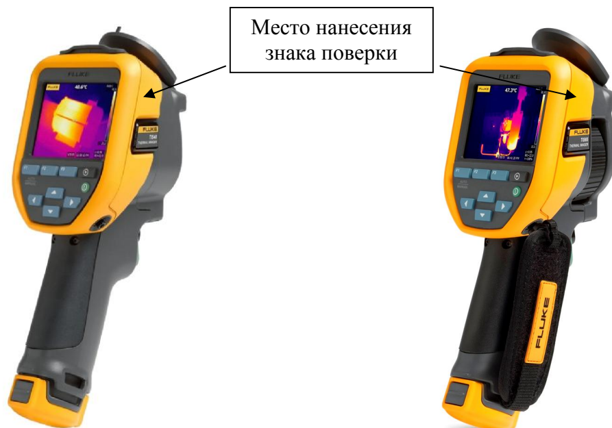
Рисунок 1 - Общий вид тепловизоров инфракрасных Fluke моделей TiS10, TiS20, TiS40, TiS50, TiS60
