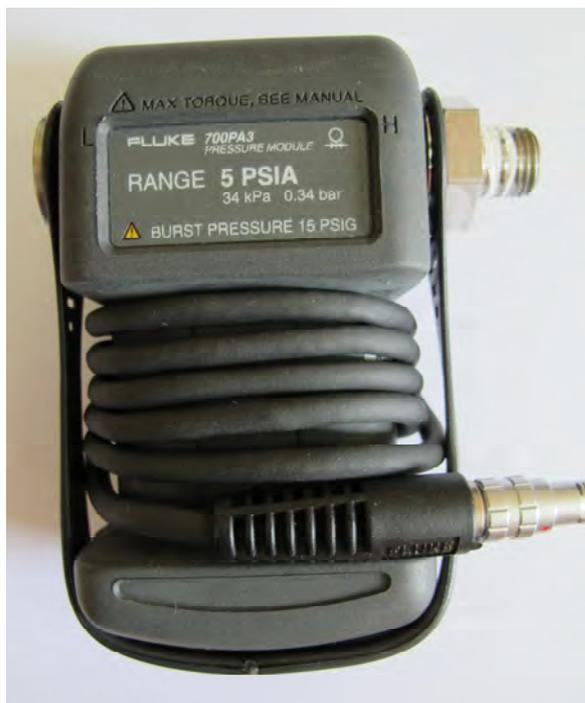
Рисунок 1. Внешний вид модулей давления Fluke 700Pxx
