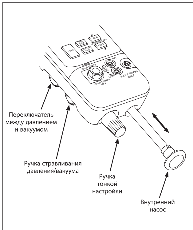
Рисунок 3. Элементы насоса
