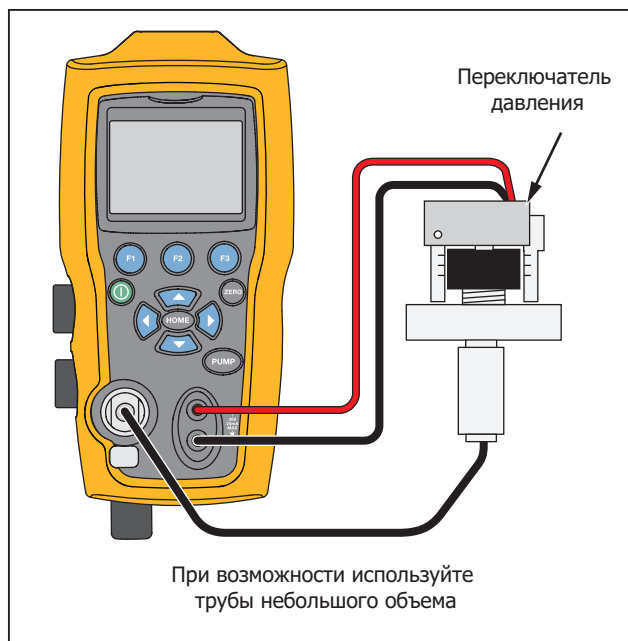
Рисунок 8. Подключение переключателя давления
