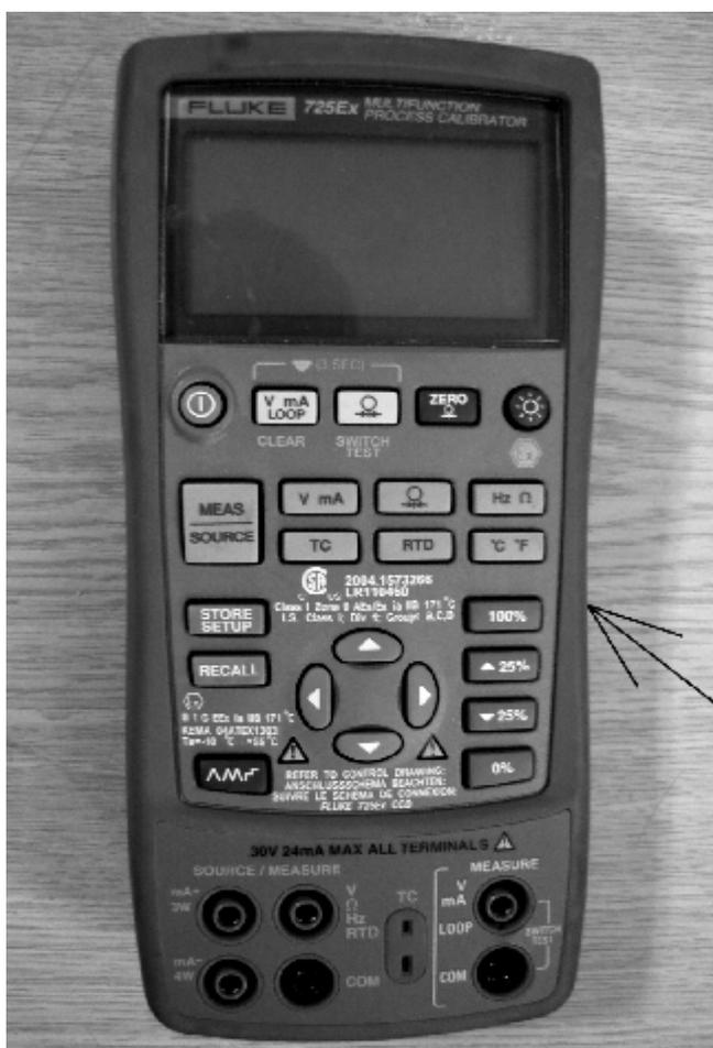
Рисунок 1 - Внешний вид измерителя, стрелкой показано место нанесения знака утверждения типа.
