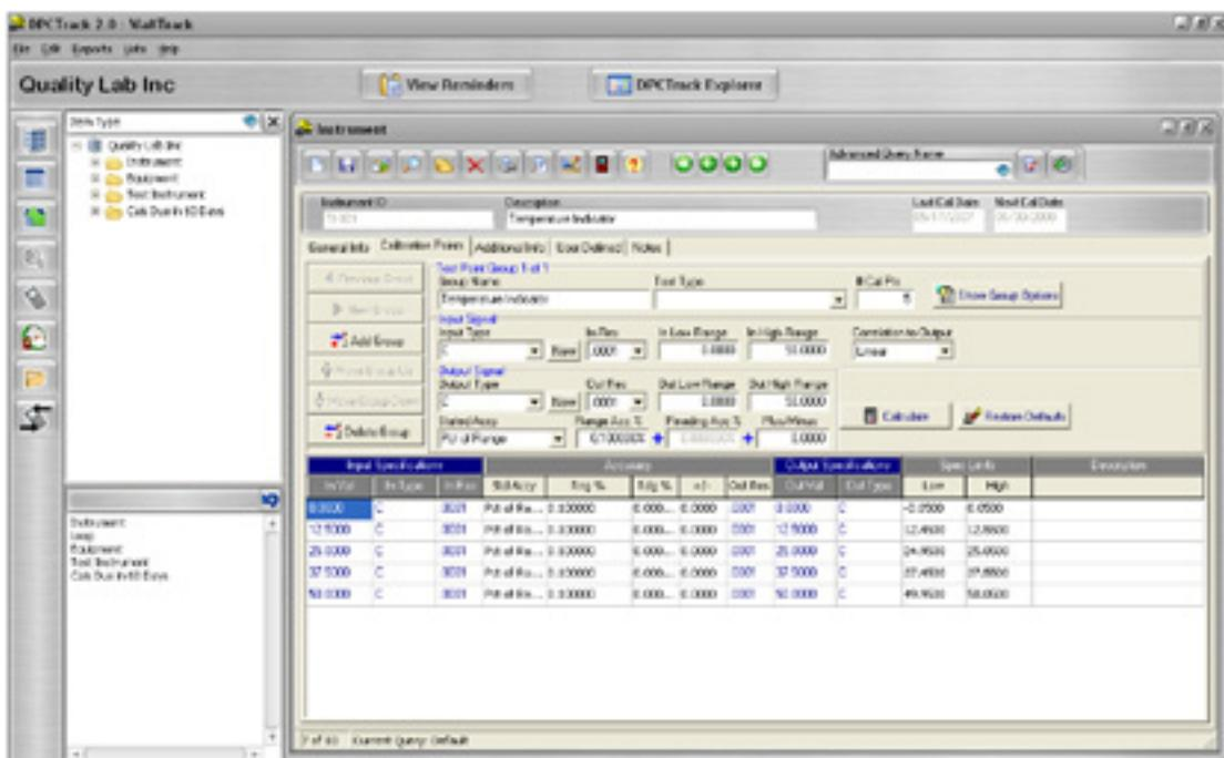
Программное обеспечение Fluke 750SW DPC/TRACK 2 включает в себя базу данных оборудования, которая облегчает управление вашим оборудованием, создание и планирование тестов, нагрузку и разгрузку 753 или 754, распечатку различных стандартных отчетов, управление данными калибровки.
