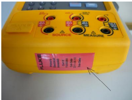
Рисунок 2 - Место пломбирования от несанкционированного доступа
