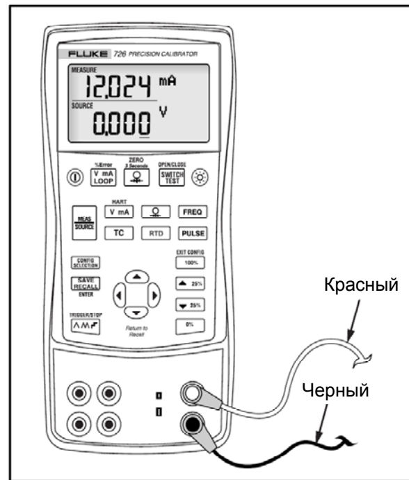
Рисунок 7. Измерение напряжения и силы тока выходного сигнала.
