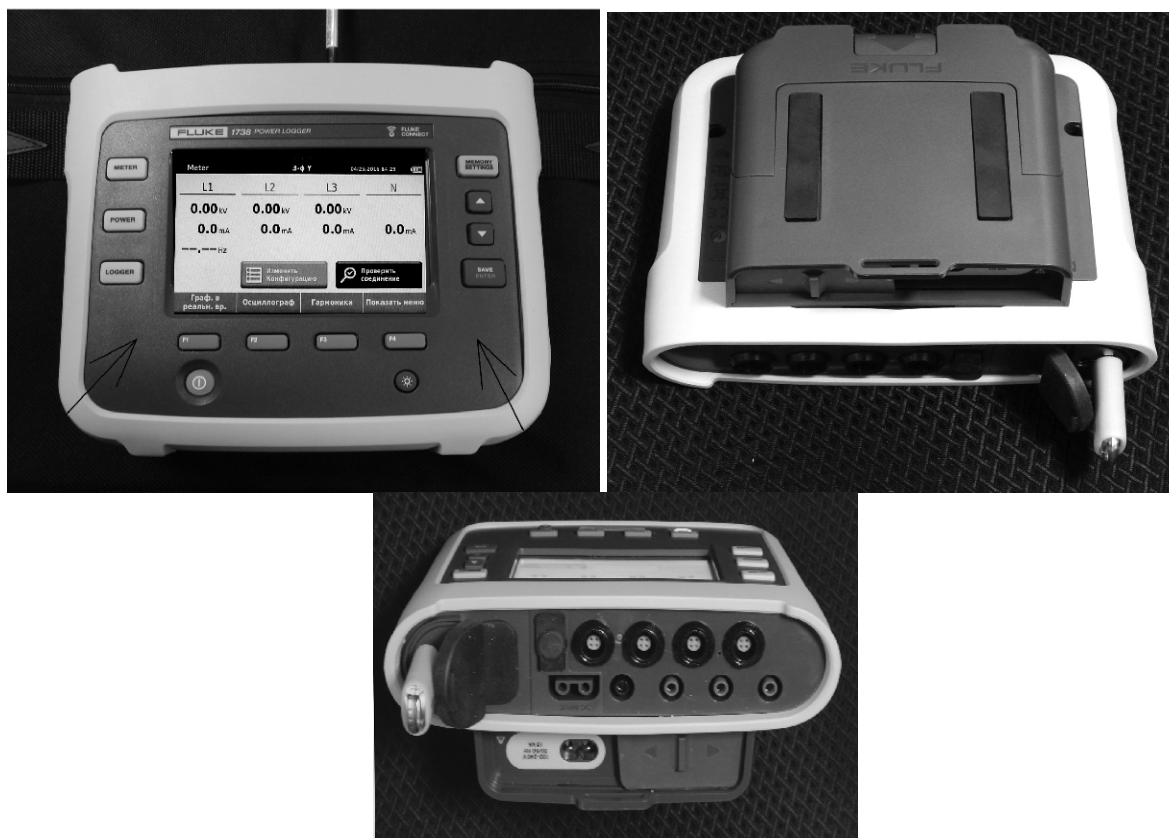
Рисунок 1 - Внешний вид регистраторов параметров электроэнергии трехфазных Fluke 1736, Fluke 1738
