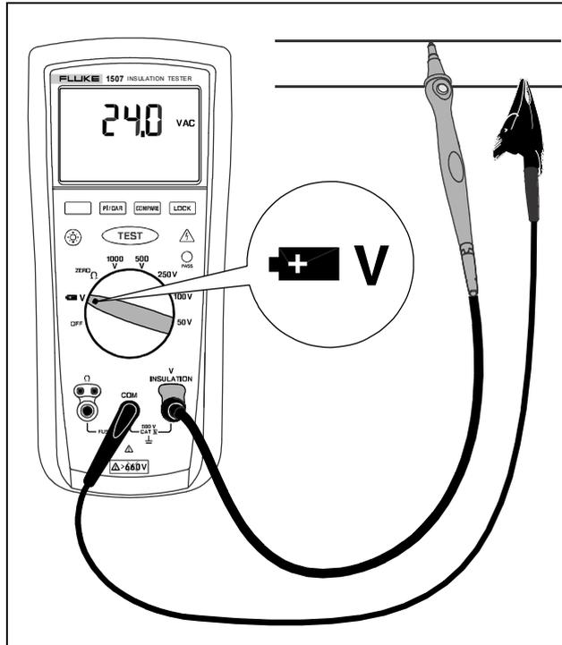
Рисунок 5. Измерение Напряжения
