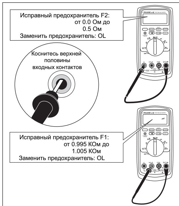
Рисунок 10. Контроль предохранителей тока
