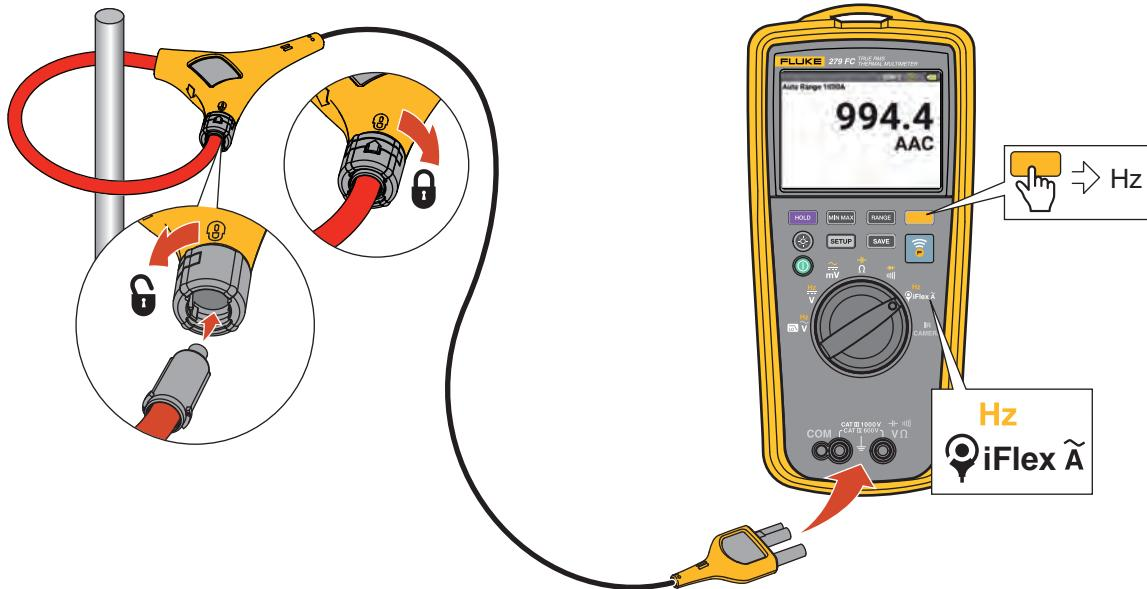
**Рисунок 10. Измерения переменного тока**
