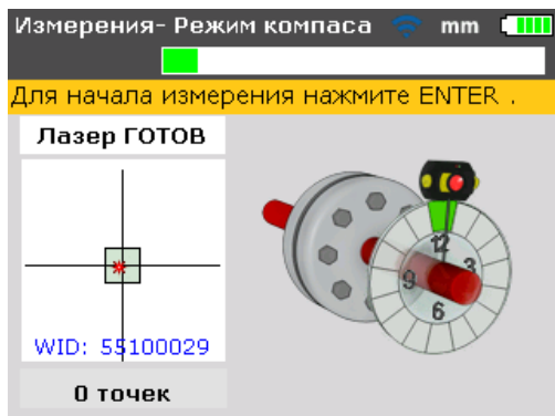
Рис. 6-3. Центрирование отраженного лазерного луча с помощью координатного манипулятора и желтой ручки регулирования луча
