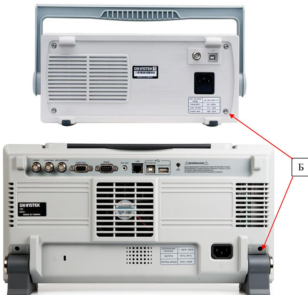
Рисунок 3 –Схема пломбировки от несанкционированного доступа (Б)
