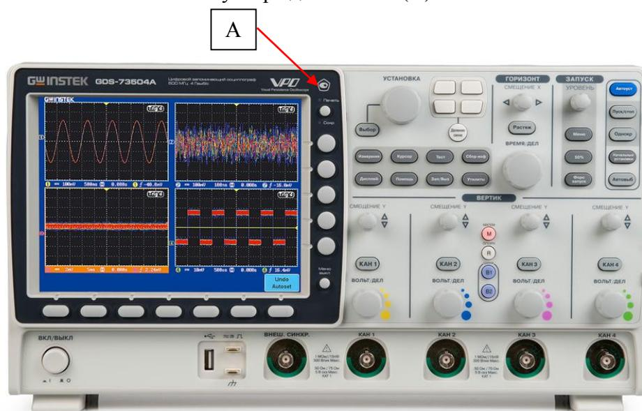
Рисунок 2 – Внешний вид осциллографов серии GDS-73000 и место нанесения знака утверждения типа (А)
