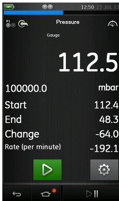
Рис. 3-10. Пример проверки на утечки
