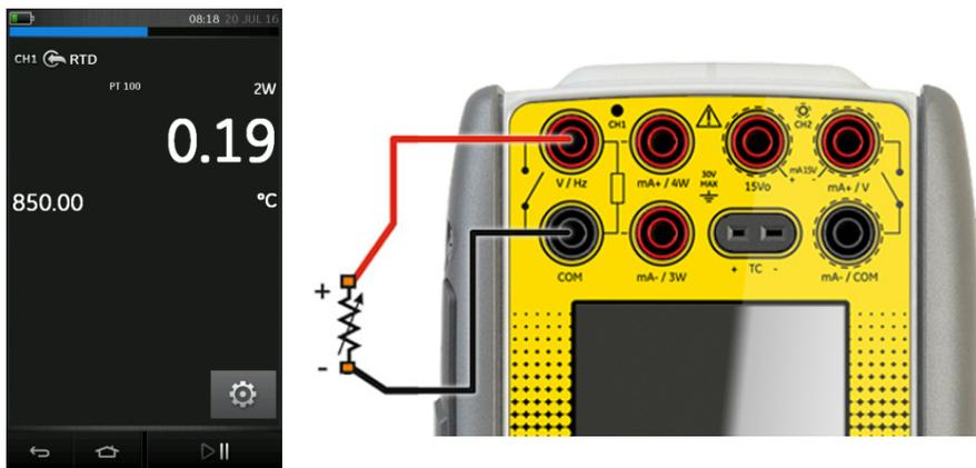
**Рис. 2-26. Измерение РДТ PT100 в канале 1 2-проводным методом (диапазон от -200 до 850 °C)**
