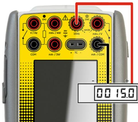
**Рис. 2-15.** Подключение к выходу нерегулируемого токового контура 15Vo
