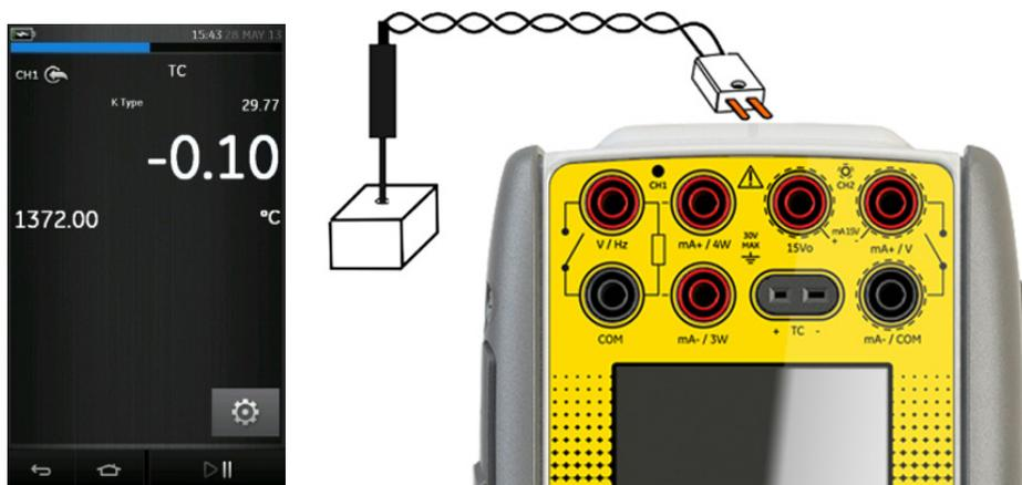
Рис. 2-27. Измерение температуры по терморезистору типа К в канале 1 (диапазон от -270 до 1372 °C)
