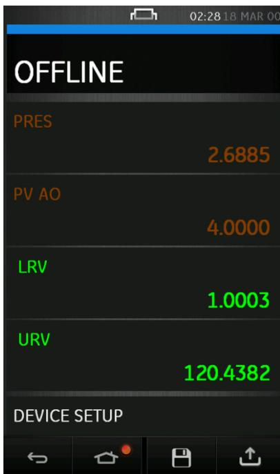
**Рис. 7-3. Автономная конфигурация устройства**
