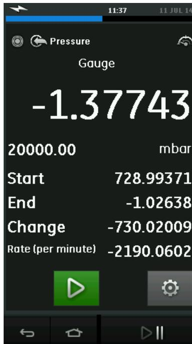
Рисунок 2-20 Пример утилиты Тест герметичности (Leak Test)
