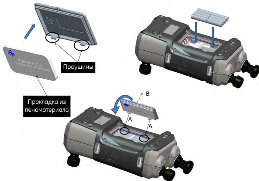
Рис. 1-2. Установка батарей с сухими элементами
