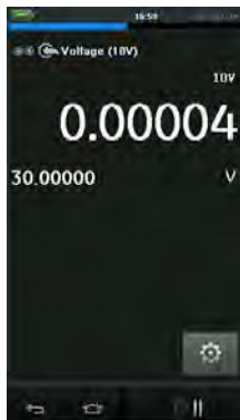
Рис. 2-25. Измерение напряжения пост. тока (10 V) или пост. тока в мВ (10 V) в канале CH1
