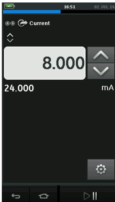
Рис. 2-23. Ток источника с внешним источником питания контура (диапазон: от 0 до 24 мА)
