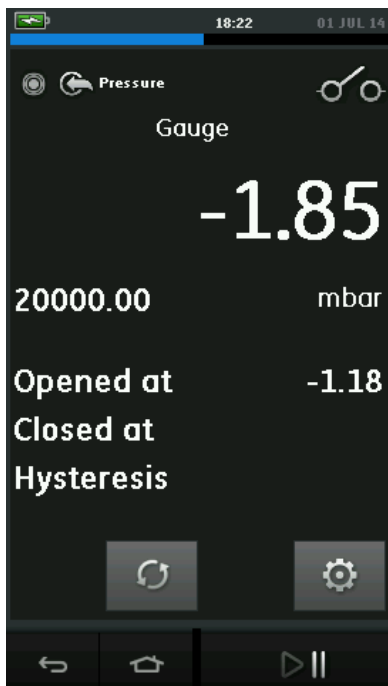
Рис. 2-15. Пример тестирования переключателя
