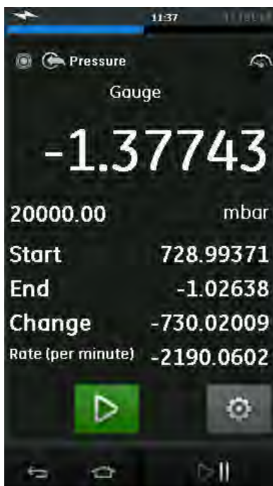
Рис. 2-27. Пример проверки на утечки
