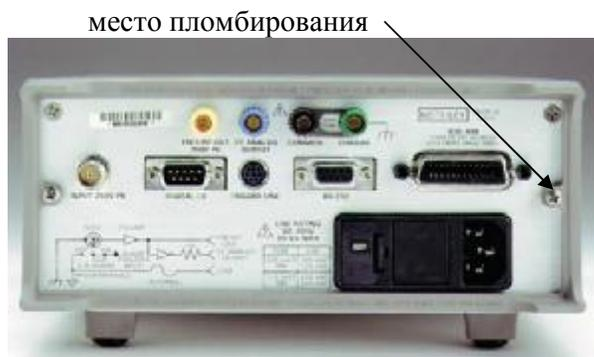
Рис. 2 – Задняя панель
