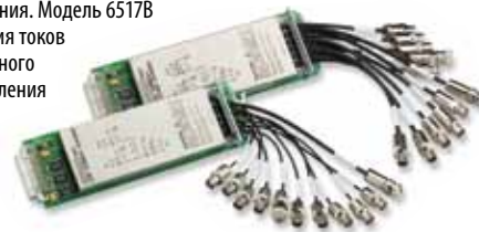
Платы 10-канальных мультиплексов моделей 6521 и 6522. Устанавливаются в слот расширения модели 6517B, расположенный на задней панели, для многоканального измерения малых токов
