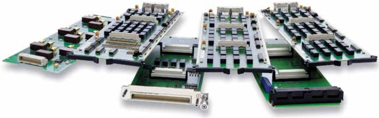
Платы коммутации и управления для моделей 7001 и 7002
