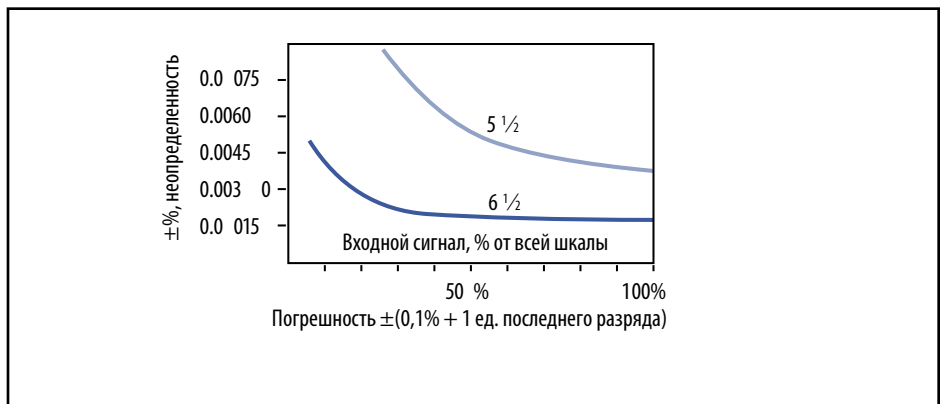
Рис. 2. Расчетная неопределенность результатов измерений для 5\frac{1}{2} - и 6\frac{1}{2} -разрядных цифровых мультиметров.
