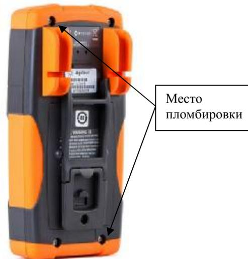
Рисунок 2 - Задняя панель мультиметров
