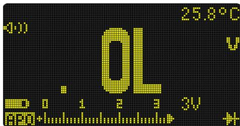
**Рисунок 2-21** Экран для хорошего диода
