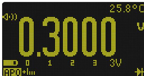
**Рисунок 2-20** Экран проверки диода
