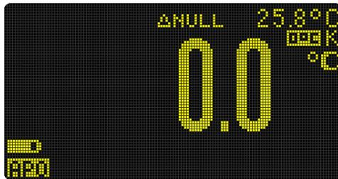
Рисунок 2-30 Измерение температуры без компенсации окружающей температуры
