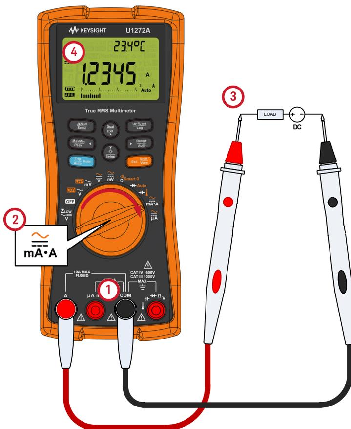
Рисунок 2-32 Измерение пост. тока
