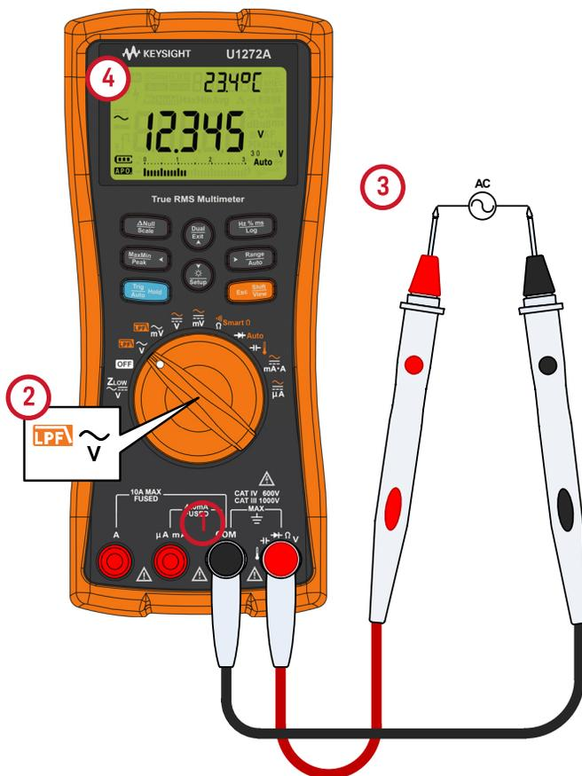
Рисунок 2-2 Измерение переменного напряжения
