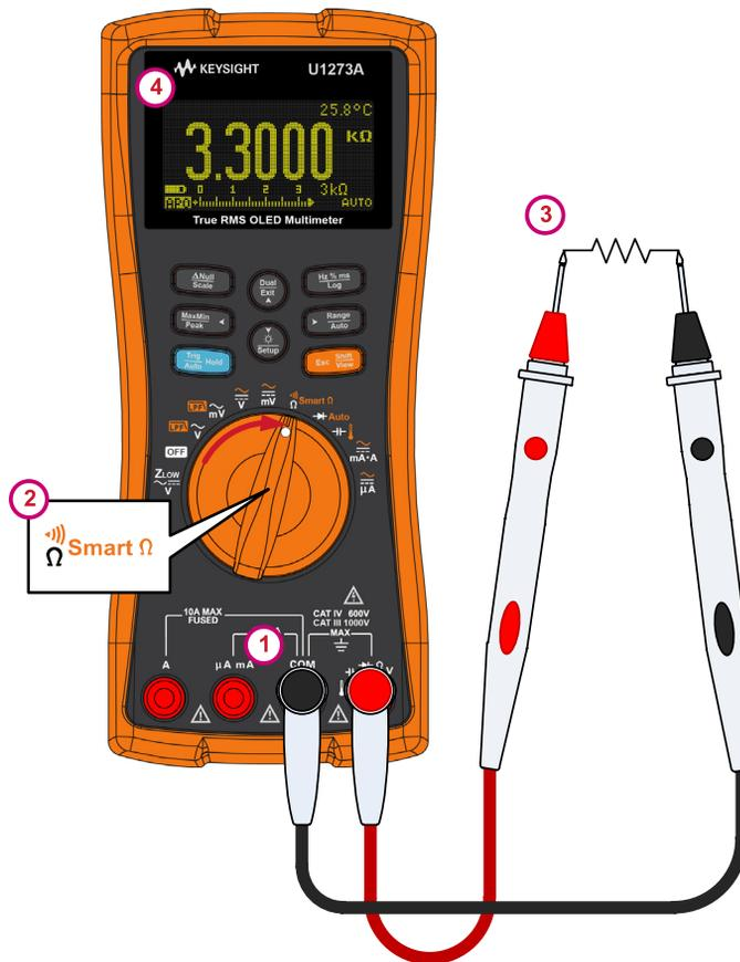
Рисунок 2-14 Измерение сопротивления
