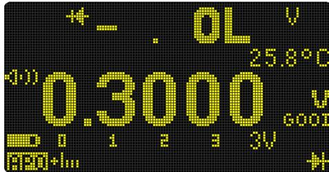
Рисунок 2-24 Экран автопроверки диодов — годен (GOOD)
