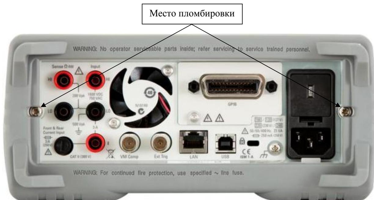
Рисунок 4 – Общий вид мультиметров цифровых 34461А. Вид сзади.
